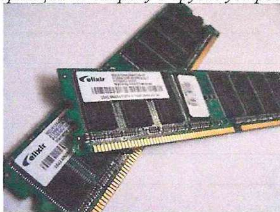
Рисунок 5 - ОЗУ (Оперативное запоминающее устройство) компьютера
